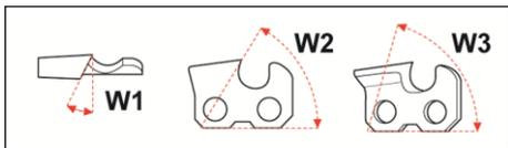
W1 Angle d'affûtage en fonction de la chaîne de scie 25° - 35°
