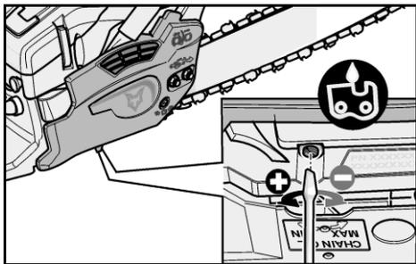
El tornillo de ajuste de dosificación de aceite se encuentra en la parte inferior de la motosierra.
