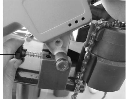
7. Abhängig von der Menge an Material dass abtragen möchten, befestigen oder lösen Sie Schraube (#51) und ziehen Sie die Mutter an. Siehe Abb.5. Schraube 51 hat eine Muttersperre mit der sich einstellen lässt wie viel Material abgetragen wird. Wenn Sie die Mutter gesetzt haben, ziehen Sie die Schraube (#51) ganz an.
